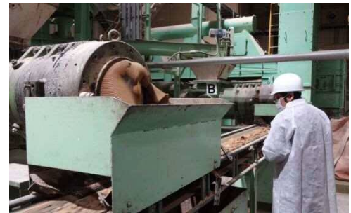
＜米糠を板状に加工する工程＞
